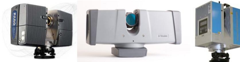
Terrestrische Laserscanner für Untersuchungen an der HafenCity Universität Hamburg: Faro Photon 80/120, Trimble FX und IMAGER 5006i von Zoller & Fröhlich
