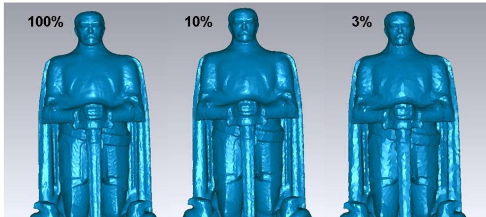
Visueller Eindruck der Polygonezimirung in Geomagic auf das 3D-Modell der Bismarckfigur
