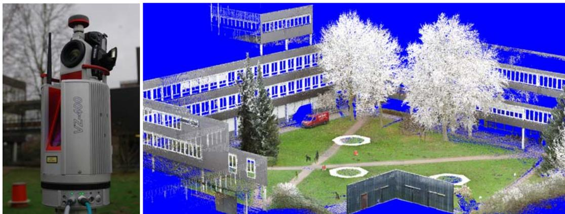
Adaptierte Kamera auf dem neuen Scanner Riegl VZ400 und eine eingefärbte Punktwolke vom Campus City Nord
