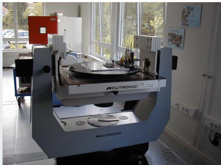
Testaufbau des Gyroskop-Tests auf einem Dreiachsdrehtisch
