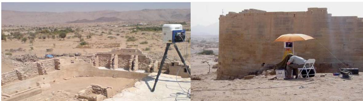
Aufnahme des antiken Tempels in Sirwah/Jemen mit dem Laserscanner Trimble GS101
