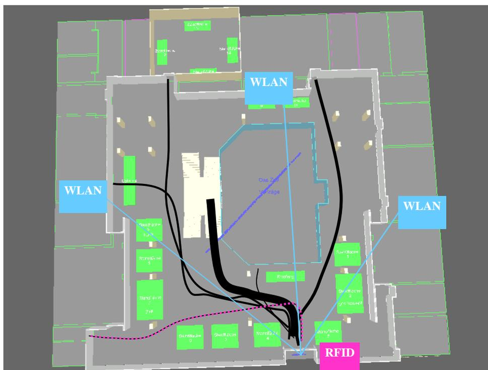
Einsatz von Infrastruktur-Sensoren zur Positionsbestimmung im Gebäude
