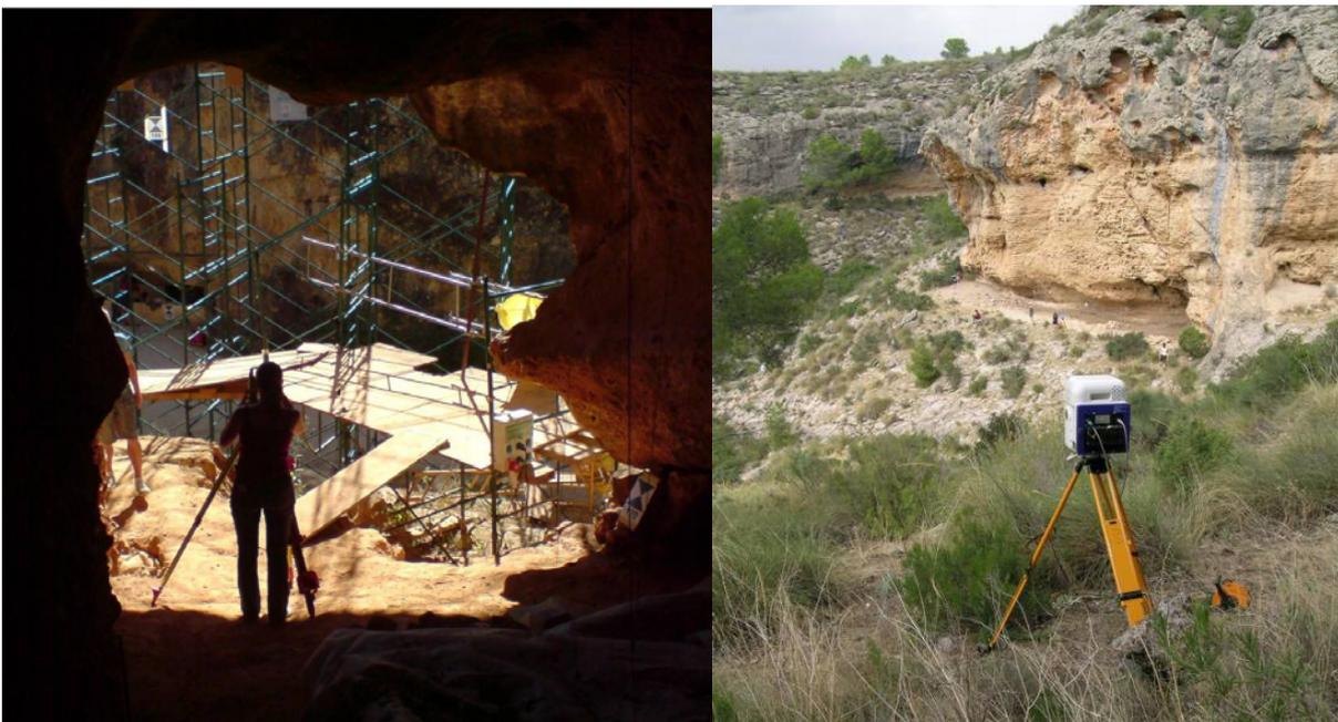
Vermessung von Passpunkten am Höhleneingang und Laserscanner Mensi GS100 von Trimble im Gelände
