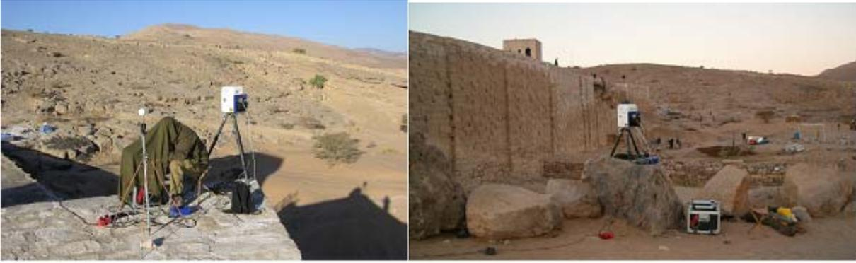
Terrestrisches Laserscanning am Nordbau des antiken Staudammes in Marib/Jemen
