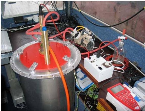
Rohrmesseinheit mit Vakuumpumpe
