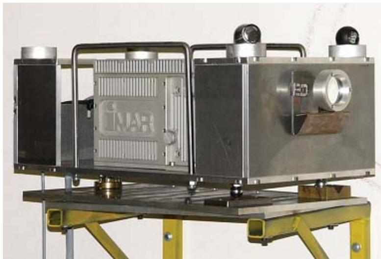
Inertialsystem mit Ringlaserkreiseln und Autokollimationseinrichtung zur hochgenauen Richtungsübertragung
