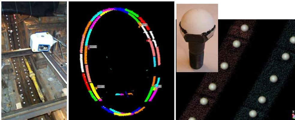
U-Bahntunnel Gänsemarkt Hamburg v.l.n.r.: Laserscanner im Tunnel, farbkodierte Punktwolken, Halbkugel-Adapter und automatisch eingepasste Kugeln (Spheres)
