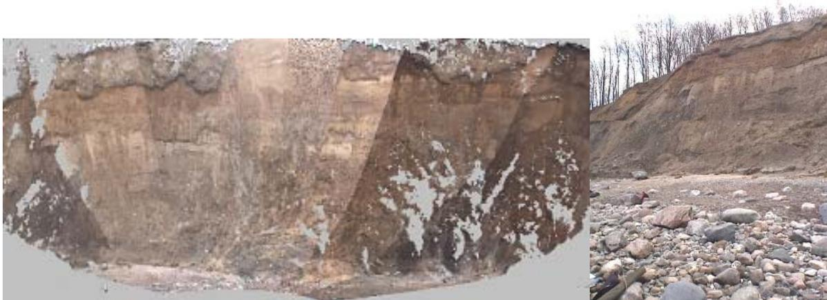
Steilufer Brodten – texturierte Punktwolke des Mensi GS100 Laserscanners (links), Fotos der eingebauten Kamera (rechts)
