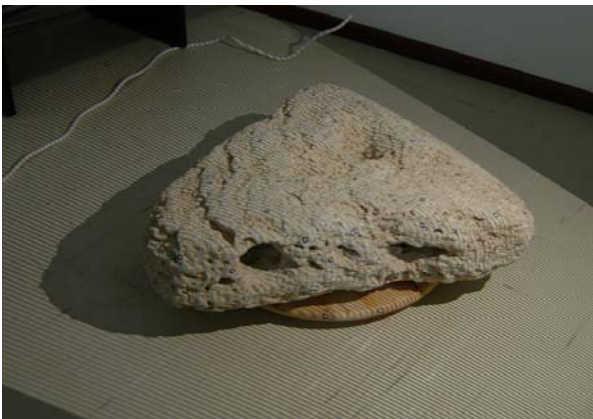
Datenerfassung eines Ankersteins mit dem ATOS I 2M.
