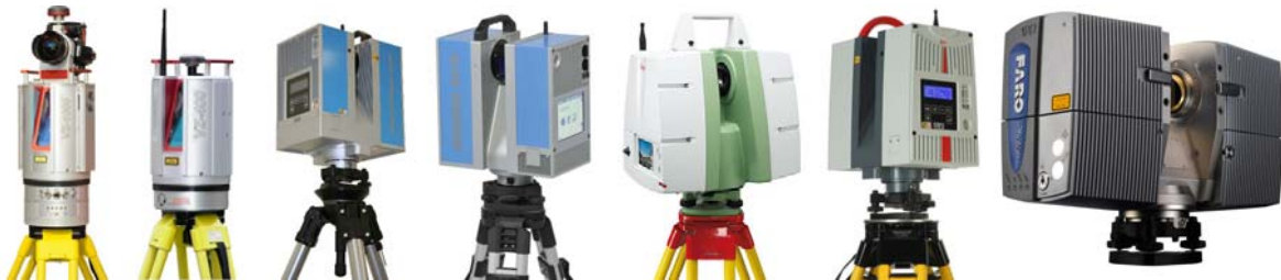
Untersuchte terrestrische Laserscanner an der HafenCity Universität Hamburg im Rahmen des Workshops „Prüfverfahren für terrestrische Laserscanner“: Riegl VZ-1000 und VZ-400, IMAGER 5006 und IMAGER 5010 von Zoller & Fröhlich Leica, Leica C10 und HDS6000 sowie Faro Photon 120
