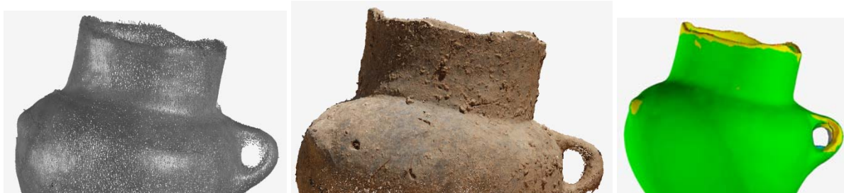
Keramik aus Yeha - Punktwolke vom Laserscanner (links) und durch Dense Image Matching (Mitte), Differenz zwischen beiden Datensätzen (grün \leq 1 mm, rechts)
