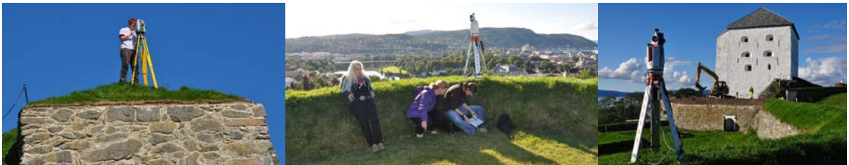
Geodätische Netzmessung und Laserscanning an der Festung Kristiansten in Trondheim
