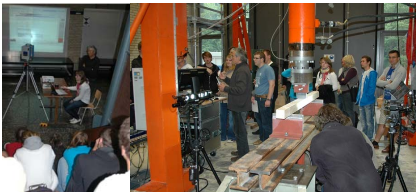
Demonstration eines Laserscanners, Deformationserfassung mit photogrammetrischem System ARAMIS
