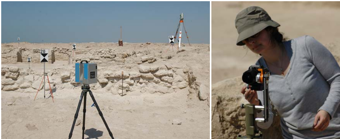
Terrestrischer Laserscanner IMAGER 5006i und Totalstation Leica TCRP1201 bei der 3D-Aufnahme der ehemaligen Perlenfischerstadt Al Zubarah in Katar (links), Panoramaaufnahme mit der Nikon D40 auf dem Nodalpunktadapter durch Tanja Graeger (rechts)
