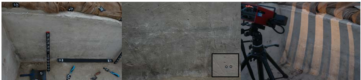
Aufnahme einer in Stein geritzten arabischen Dau durch Streifenprojektion
