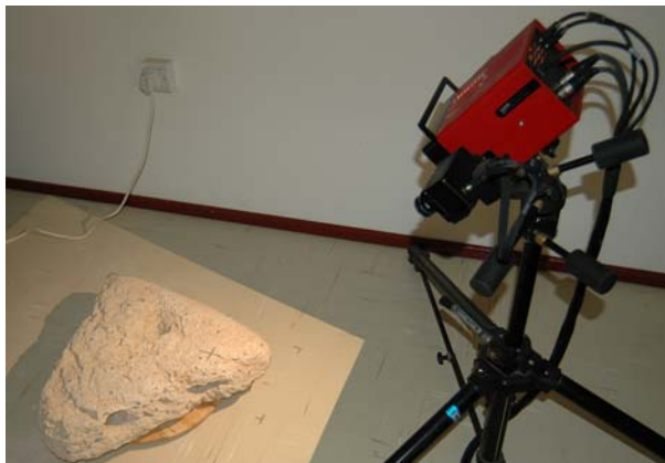
Datenerfassung eines Ankersteins mit dem ATOS I 2M.
