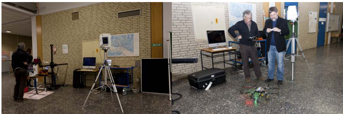
Das Streifenprojektionssystem ATOS I neben dem Laserscanner Trimble GS100 im Einsatz
