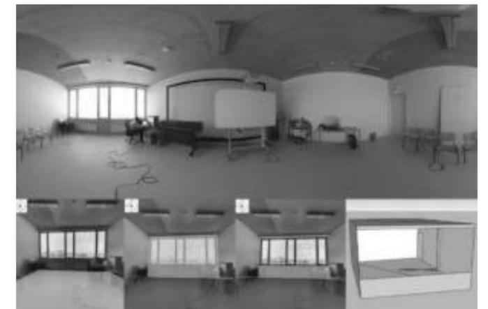
Abb. 3 Erstelltes Panoramabild (oben) und 3D-Raummodellierung (unten, v.l.n.r.): Bestimmung des Bodens, Bestimmung einer Wand, Bestimmung der Fensteröffnung und Beispiel für einen einfachen rekonstruierten Raum
