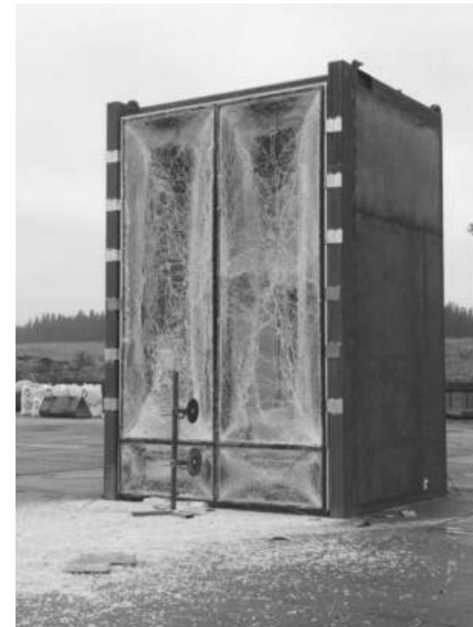
Abb. 1 und 2 Freifeldexplosionsversuch an Fassadenelementen
