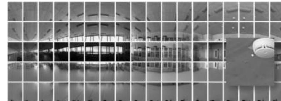
Abb. 2 Aufnahmen mit dem HCU 3D-IMAGER: 5 Reihen mal 18 Einzelbilder zu einem Panorama angeordnet und Einzelbild mit Laserpunkt als Ausschnitt (rechts)
