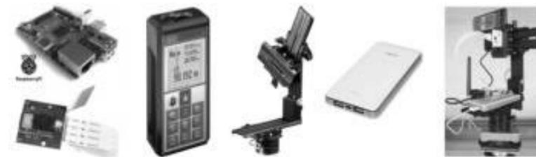
Abb. 1 Systemkomponenten des HCU 3D-IMAGER (v.l.n.r.): Raspberry Pi Computer und Kamera, Bosch Laserdistanzmessgerät, Manfrotto Panoramakopf, USB-Powerbank und das zusammengebaute HCU-Aufnahmesystem 3D-IMAGER
