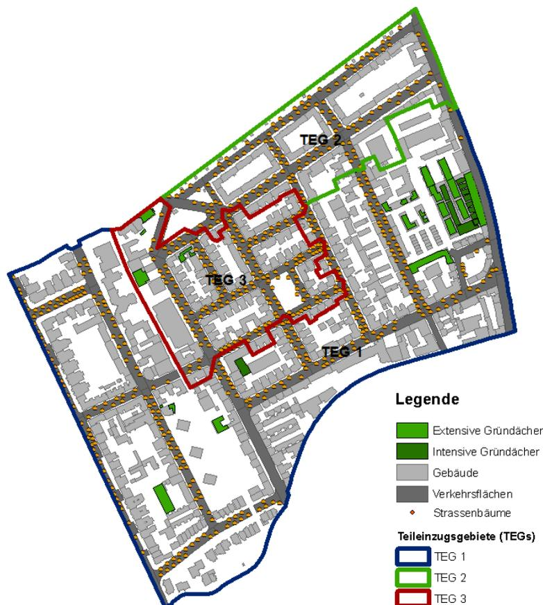
**Abbildung 2: Lage der Straßenbäume und Darstellung der verwendeten Flächen für die Simulation des Ist-Zustandes (Grünflächen werden aus Übersichtsgründen nicht dargestellt)**
