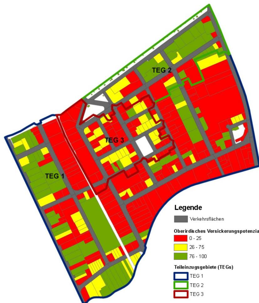
**Abbildung 4: Darstellung des Potenzials zur Versickerung von Niederschlagswasser auf Privatgrundstücken mit Mulden**
