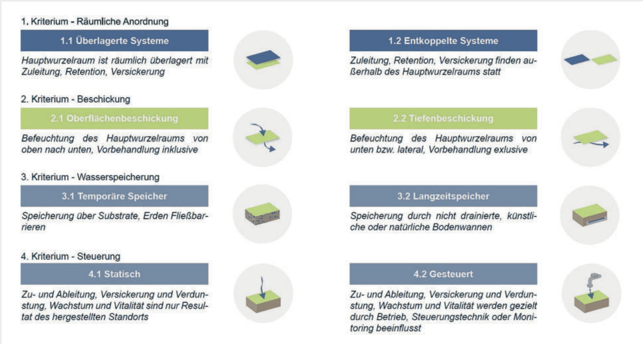
Fig. 3 Typologien Bäume und Regenwasserbewirtschaftung nach BGS 2.0. (Grafik: BGS, Ingenieurgesellschaft Sieker)
