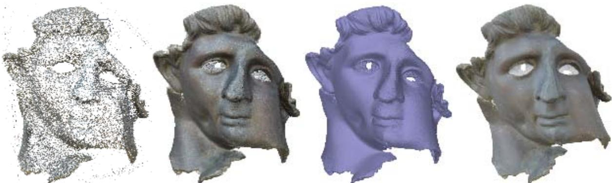
Abb. 3: Rekonstruiertes Gesicht der Bronzestatue (von links nach rechts) – grobe Punktwolke für die Bildorientierung und Kamerakalibrierung, dichte Punktwolke, vermaschte Punktwolke und texturierte Dreiecksvermaschung
