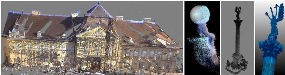
**Abb. 7:** v.l.n.r.: 3D-Punktwolke der Gebäudefassade des Bischofsitzes in Székesfehérvár, manuell konstruierte Kugel eines Fassadenteils für die Verknüpfung der Punktwolken, Punktwolke der Säule am Platz „1000 jähriges Ungarn“, Budapest
