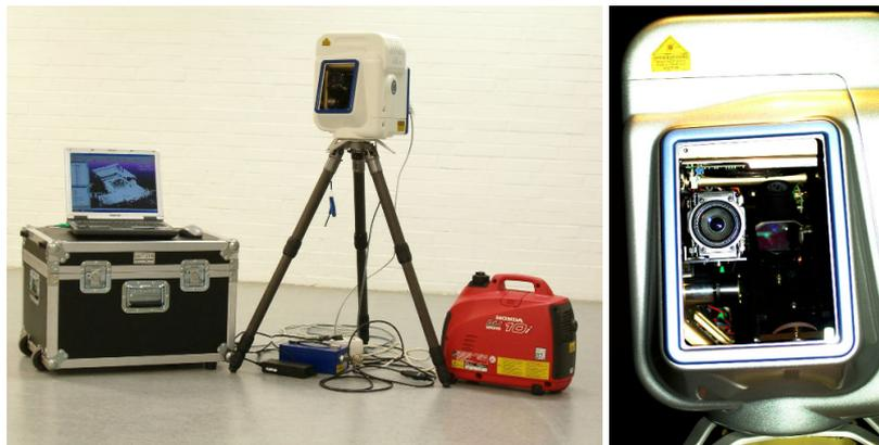
**Abb.1:** Das 3D-Laserscanning System Mensi GS100 der HAW Hamburg mit Zubehör (links) und als Innenansicht mit digitaler Kamera und Spiegel (rechts)
