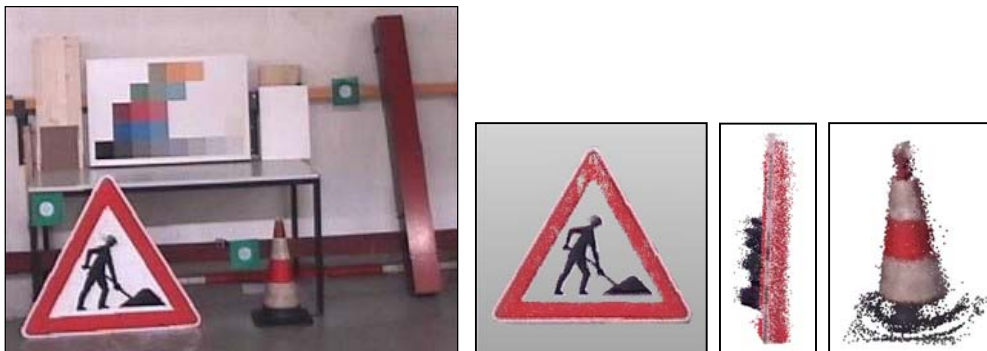
Abb. 4: Verschiedene Materialien: Übersichtsfoto (links), Punktwolken Verkehrsschild von vorne und von der Seite (Mitte) und Punktwolke Pylon (rechts)
