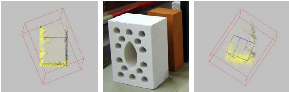
Abb. 7: Fehlerhafte Box und Bounding Box bei weißem Kalkstein (links) und rotem Ziegelstein (rechts)
