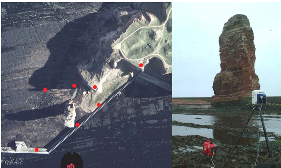
Abb. 2: Aufnahmekonfiguration (links) und Standpunkt in der Gezeitenzone (rechts)
