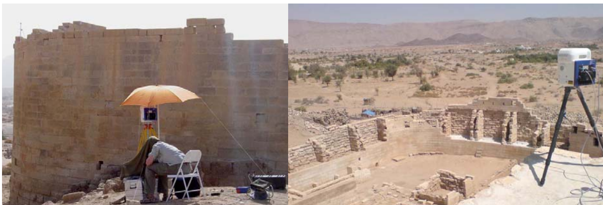
Abb. 2: Aufnahme mit dem terrestrischen Laserscanner MENSIGS101
