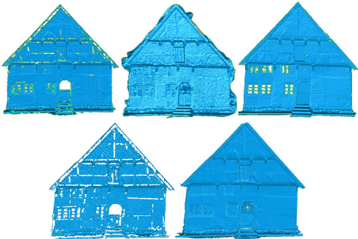
*Abb. 4: Dreiecksvermaschung der Frontfassade des Bürgerhauses: Bundler/PMVS2 (oben links), Photofly (oben Mitte), Referenzdaten vom Laserscanner IMAGER 5006h (oben rechts), VisualSFM (unten links) und PhotoScan (unten rechts).*
