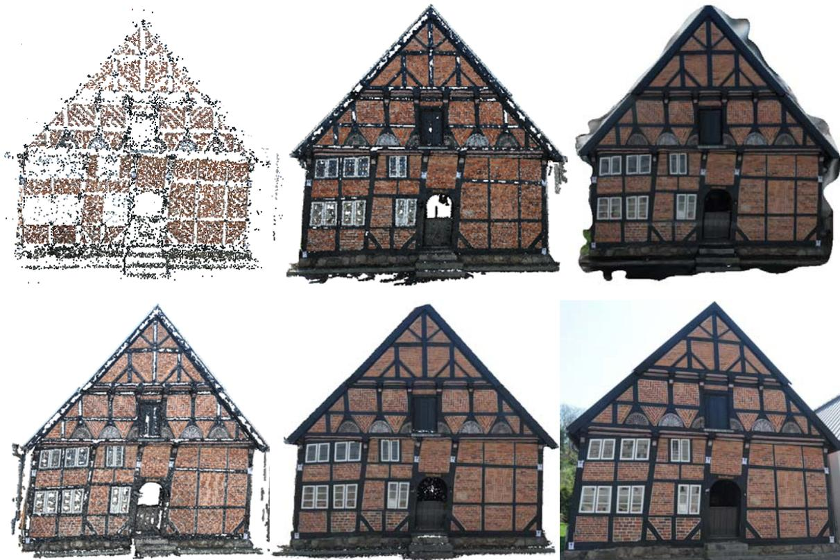
Abb. 3: Frontfassade des Alt-Segeberger Bürgerhauses: Punktwolke aus Photosynth (links oben) und Bundler/PMVS2 (oben Mitte), 3D-Vermaschung aus Photofly (rechts oben), Punktwolke aus VisualSFM (links unten), 3D-Vermaschung aus PhotoScan (unten Mitte) und Originalfoto (rechts unten).
