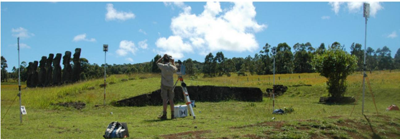
**Abb. 3** 3D-Testfeld vor dem Ahu Akivi zur Bestimmung der äusseren Orientierung der auf dem Scanner aufgesetzten Kamera.
