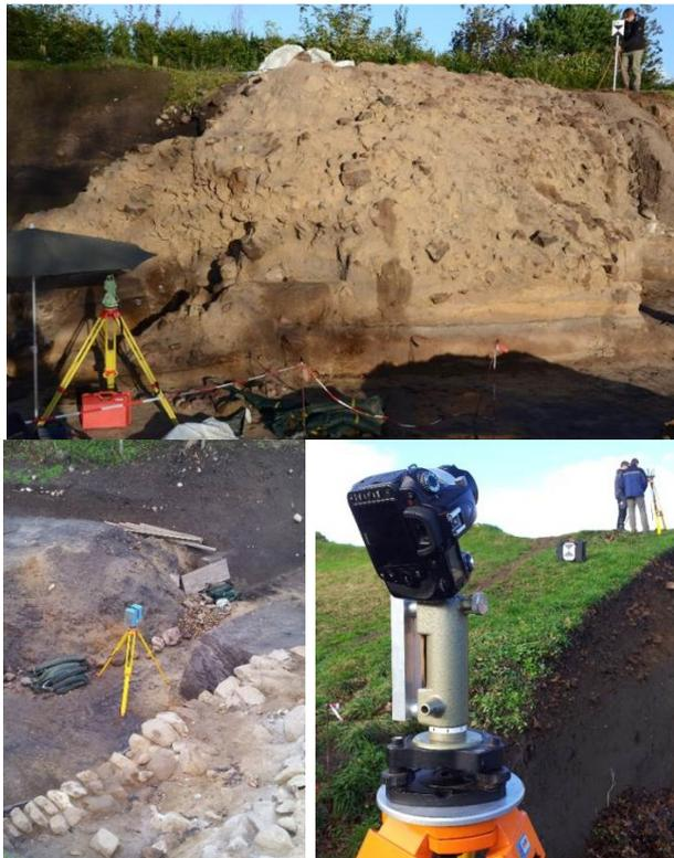
Abbildung 4. Totalstation Leica TM30 (oben), Laserscanner IMAGER 5010 (unten li) und Nikon D90 auf dem Nodalpunktadapter (unten rechts)
