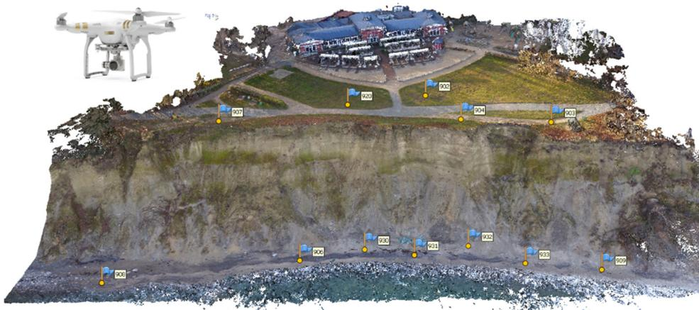
**Abb. 2:** 3D-Punktwolke vom Brodter Steilufer mit Passpunktverteilung 2018 – UAV-Befliegung mit einer DJI Phantom 3
