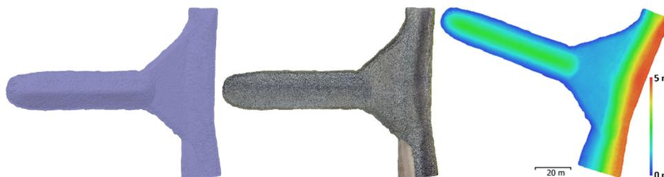
**Abb. 4:** Vermaschtes (links) und texturiertes 3D-Modell (Mitte) der Buhne, generiert in Agisoft PhotoScan sowie farbkodierte Darstellung des Oberflächenmodells (rechts) (UAV-Bildflug 27.07.2018)
