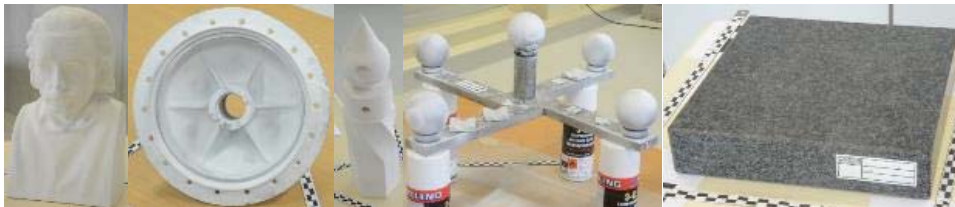
Abb. 1: Test- und Referenzkörper für die Untersuchungen der handgeführten Scanner-systeme – v.l.n.r. Einstein-Büste, Radnabe, Testy, Referenzkörper HSBO mit Kugeln und Granitplatte.
