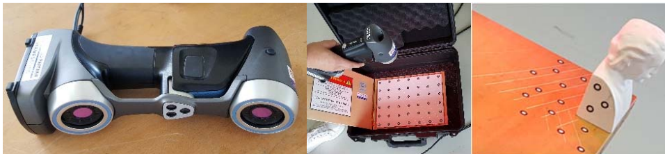
Abb. 2: Sensorsystem Creaform HandySCAN 700 (links), Kalibrierplatte (Mitte) und Laserfadenkreuze am Aufnahmeobjekt (rechts)
