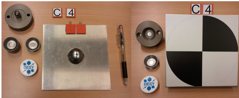
Abb. 4: In Zusammenarbeit mit dem DESY Hamburg entwickeltes Target mit stabiler Befestigung im Punktnest eines Lasertrackers
