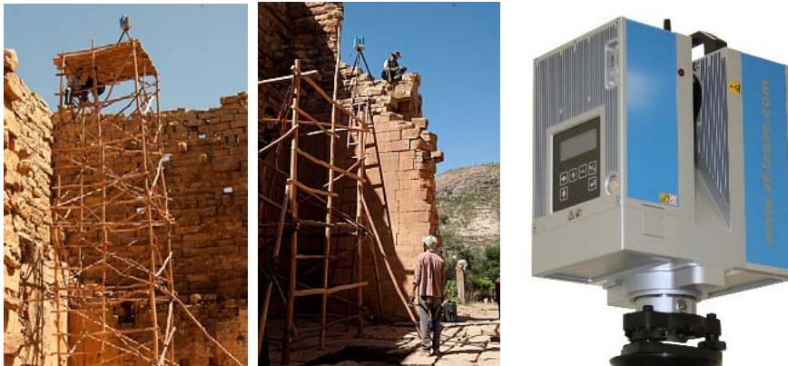
Abb. 2: Eingesetzter Laserscanner IMAGER 5006 von Zoller + Fröhlich (rechts) auf Gerüstturm (links) und auf der Tempelmauer (Mitte)
