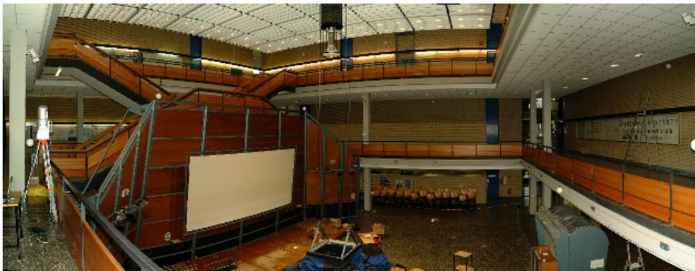
**Abb. 2:** 3D Testfeld der HafenCity Universität Hamburg für die geometrische Untersuchung terrestrischer Laserscanner.
