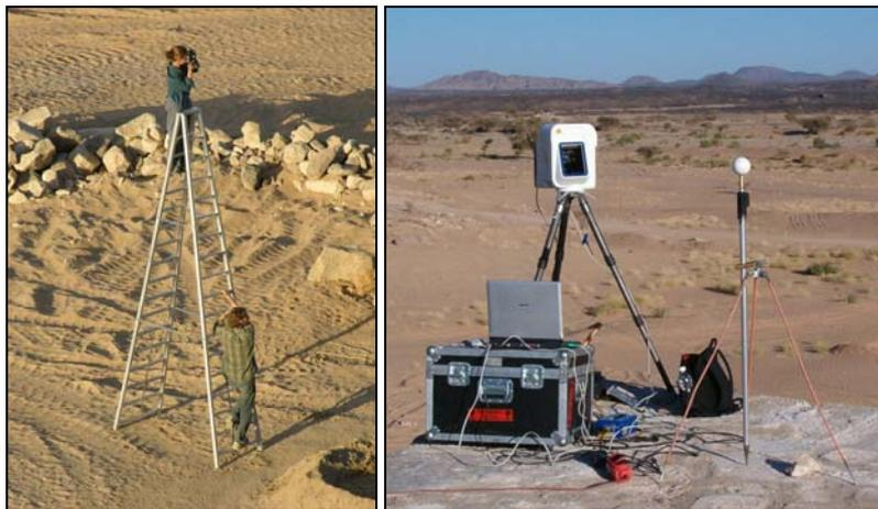
**Abb. 2:** Photogrammetrische Aufnahme (links), terrestrisches Laserscanning (rechts)
