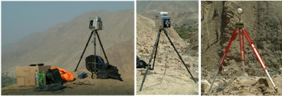
**Abb.93:** Trimble GS200 vor Ort im Einsatz (links, Mitte), Kugel zur Standpunktverknüpfung (rechts)
