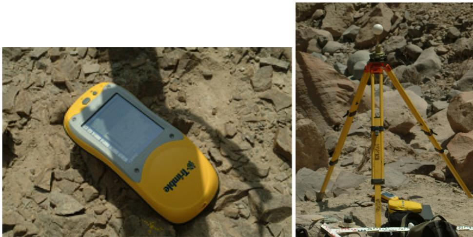
**Abb.95:** GPS-Empfänger (rechts) auf einem 3D-Netzpunkt (Referenz- bzw. Verknüpfungspunkt für die Punktwolken vom Laserscanning)
