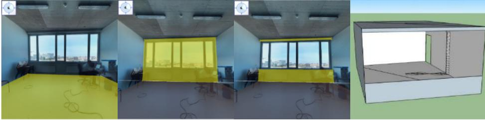
**Abb. 8:** 3D-Raummodellierung – v.l.n.r. Bestimmung des Bodens, Bestimmung einer Wand, Bestimmung der Fensteröffnung und Beispiel für einen einfachen rekonstruierten Raum.
