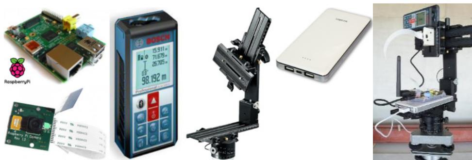
**Abb. 1:** Systemkomponenten des HCU 3D-IMAGER (v.l.n.r.): Raspberry Pi Computer und Kamera, Bosch Laserdistanzmessgerät, Manfrotto Panoramakopf, USB-Powerbank und das zusammengebaute HCU-Aufnahmesystem 3D-IMAGER
