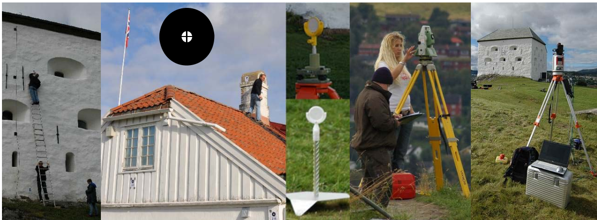
Abb. 2: Passpunktsignalisierung an den beiden Festungsgebäuden, Reflektoren für Laserscanner, geodätische Passpunktmessung und Riegl VZ-400 im Einsatz (v.l.n.r.)
