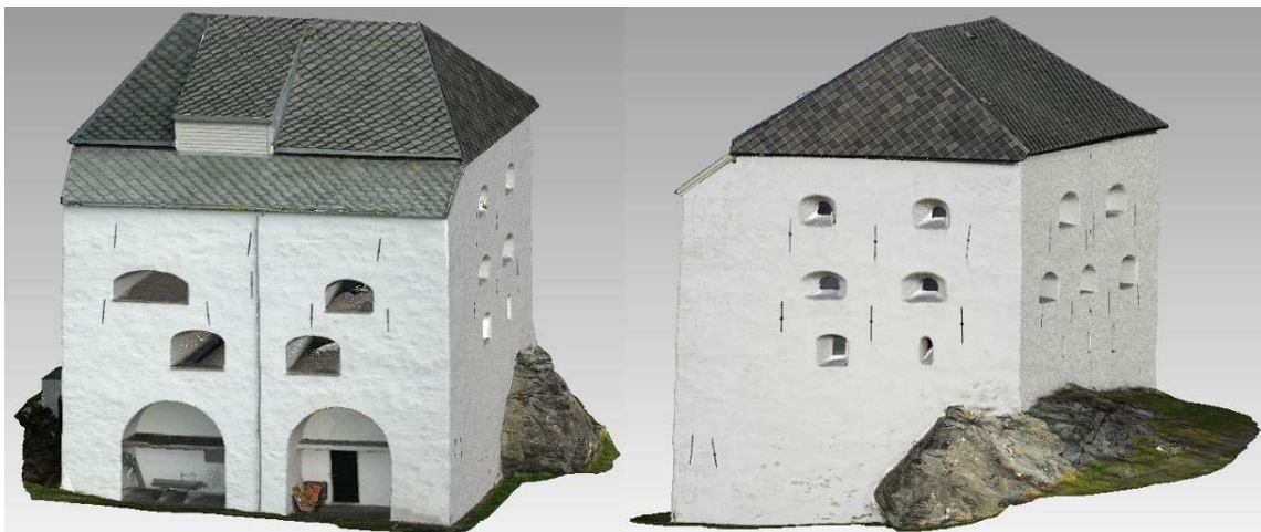
Abb. 3: Ansichten des aus Punktwolken modellierten Verteidigungsturm Donjon – Dreiecksvermaschung mit manueller Texturierung in Geomagic
