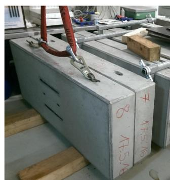
Betondeckenprobekörper für Bauteilversuche.
