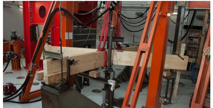
Bild 2: Prüfstand für die neuen Knotenanschlüsse
