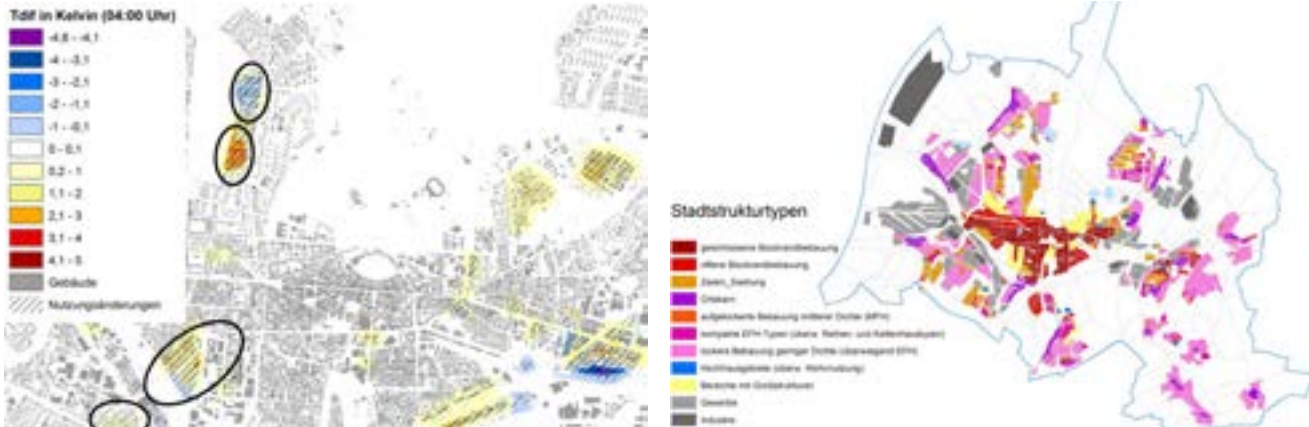
Links: Temperaturdifferenz zwischen Ausgangssituation und Szenario Nachverdichtung, 4:00 Uhr nachts, 2 m Höhe (Stadt Karlsruhe); Rechts: Stadtstrukturtypen (Stadt Karlsruhe)
