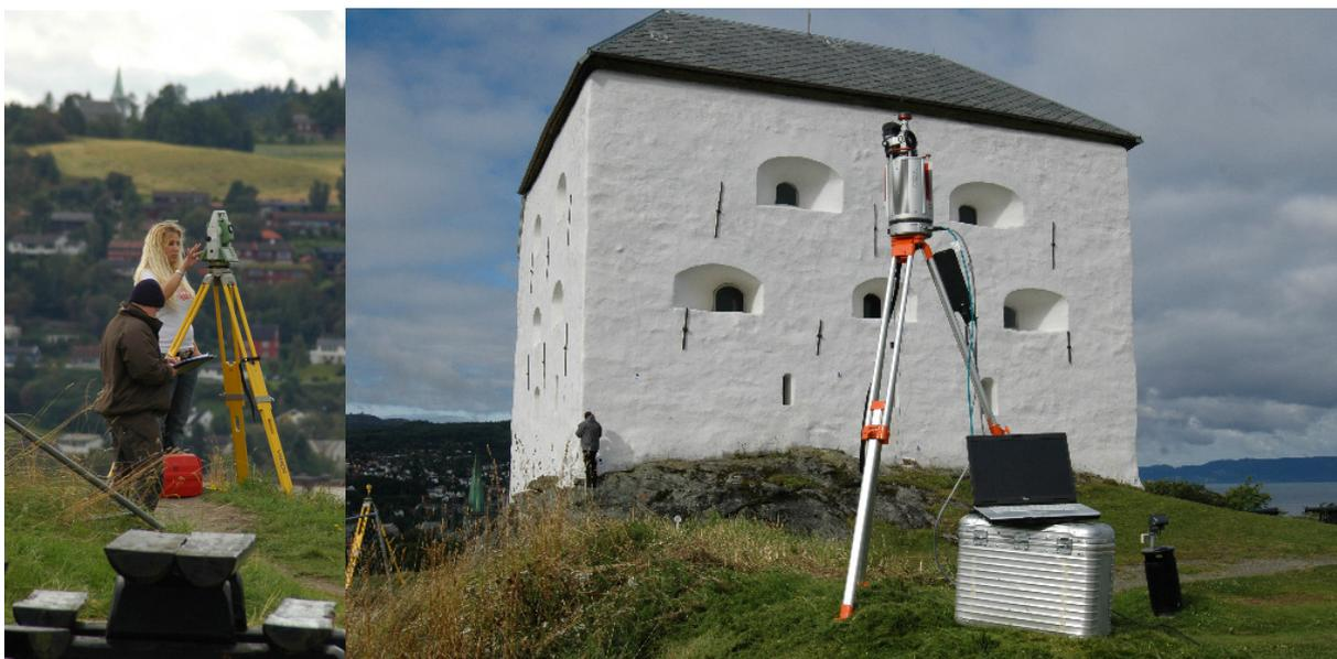
Messung des geodätischen 3D-Netzes (links) & Aufnahme des Festungsgebäudes mit dem Laserscanner Riegl VZ-400 (rechts)
