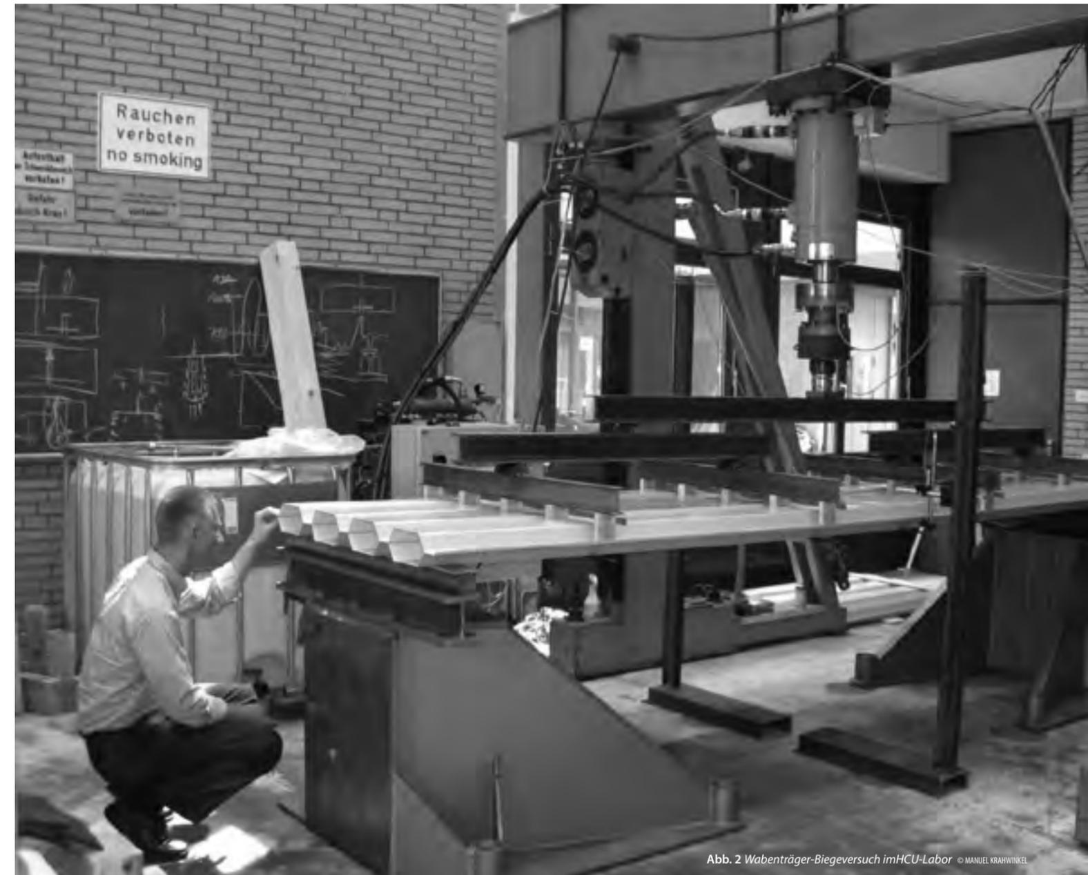
Abb. 2 Wabenträger-Biegeversuch imHCU-Labor © MANUEL KRAHWINKEL
