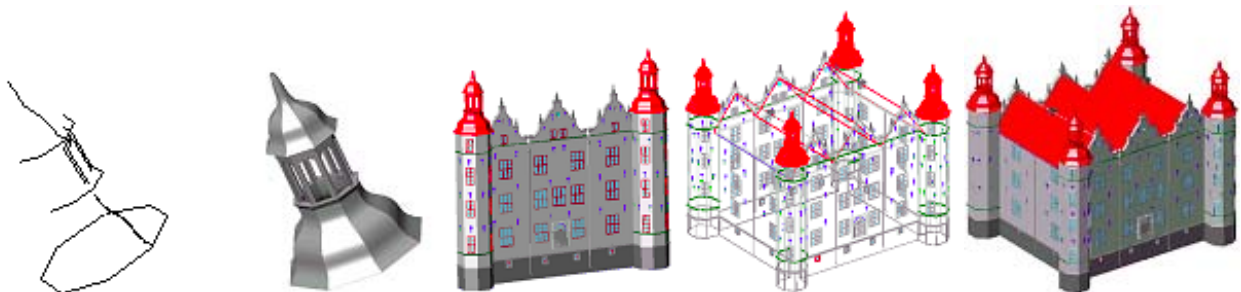
Abb. 8: 3D-CAD-Rekonstruktion des Ahrensburger Schlosses aus Einzelobjekten über Fassaden zu einem Drahtmodell und zu einem schattierten 3D-Volumenmodell
